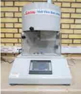
يتم في هذا الاختبار تقييم تدفق المواد في حرارة وضغط وزمان ثابت، فيعرف سلوك المواد في داخل جهاز البثق من النتائج الناتجة عن الاختبار. يُجرى هذا الاختبار على الخامات والمنتجات وفقاً لمعيار ISO 1133، وتدرس النتائج حسب الجدول التالي.
